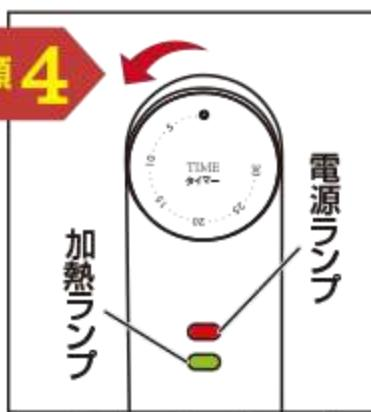
調理時間を設定。加熱ランプと電源ランプが点灯します。加熱の過程で加熱ランプ消えることがありますですが段階加熱によるもので正常な状態です。
