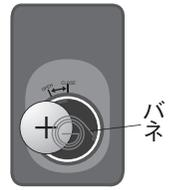
電池の+が上になっていることを確認しバネの下に電池をセットします。
